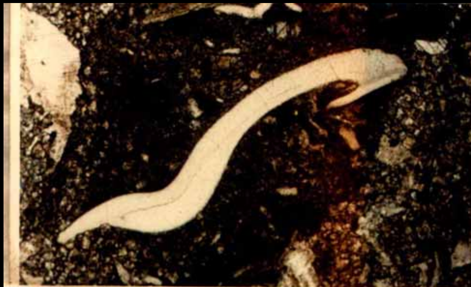
照片 III-2-【9】-(3) 三叶虫 图为三叶虫轴胸节纵切面，呈弯钩状，具玻纤结构。 湘西北杨家坪O1-244-B4 单偏光 照片长边长5mm
